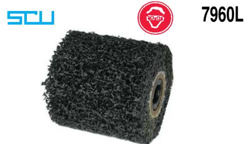
Con foro d'attacco Ø mm 19,1 e sede per chiavetta. Adatte per le più diffuse smerigliatrici, lucidatrici e satinatrici. In gomma abrasiva per satinare acciai inossidabili. Dimensioni mm 100x100. Velocità massima 1910 giri/min.
