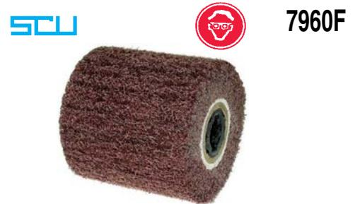
Con foro d'attacco Ø mm 19,1 e sede per chiavetta. Adatte per le più diffuse smerigliatrici, lucidatrici e satinatrici. In tessuto-non tessuto ad alta impregnazione. Abrasivo al carburo di silicio, per ottenere puliture di ruggini, sbavature di saldature, sverniciature di metalli, legni, intonaci, cemento. Non danneggia e non surriscalda la superficie da lavorare. Dimensioni mm 100x100. Velocità massima 6800 giri/min.
